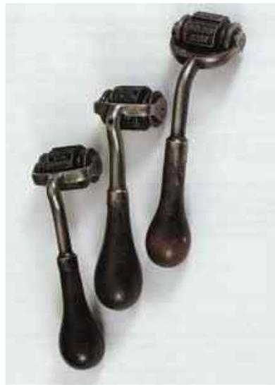
tourne dans une pièce fourchue, elle-même pourvue d'un manche en bois. Le cachet roulette manuel est démuné d'alimentation automatique d'encre et un tampon encreur est donc nécessaire.
